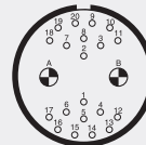
Arrangement 37-922 20 contacts size/taille 20 2 contacts size/taille 6
